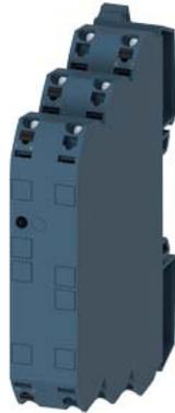
Trennwandler AC/DC 24 V, 3-Wege-Trennung Eingang: 0-60 mV, 0-100 mV 0-300 mV, 0-500 mV, 0-1 V 0-20 V, 2-10 V, 0-5 mA, 0-10 mA 2-10 V, 0-5 mA, 0-10 mA 0-20mA, 4-20mA, +5mA, +20mA Ausgang: 0 - 10 V, 0/4 - 20 mA Federzuganschluss (Push-In)
