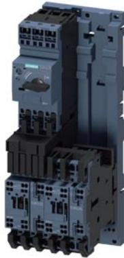
Verbraucherabzweig sicherungslos, Reversierbetrieb AC 400 V, Baugröße S0 18...25 A AC 230 V Federzuganschluss für Hutschiene montage mit Hutschieneadapter (erfüllt auch Zuordnungsart 1) Zuordnungsart 2, I<sub>q</sub> = 150 kA 1S+1Ö (Schütz)
