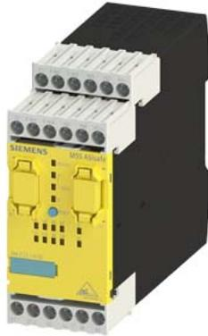
SIRIUS, Zentralmodul 3RK3 ASIsafe Extended für modulares Sicherheitssystem 3RK3 2/4F-DI,4DI,1F-RO,1F-DO,DC 24 V Monitoren von ASI slaves Ansteuern von 10 sicheren Ausgängen am AS-Interface Bus parametrierbar mit SW Safety ES 45 mm Baubreite Schraubanschluss bis SIL3 (IEC 61508) bis Performance Level E (ISO 13849-1) 2 Erweiterungsmodule anschließbar
