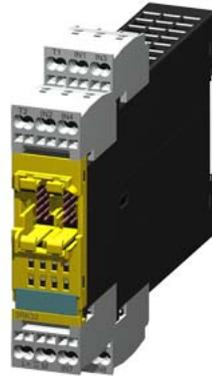
SIRIUS, Erweiterungsmodul 3RK32 für modulares Sicherheitssystem 3RK3 2/4 F-DI, 1/2 F-RO, DC24 V/1 A parametrierbar über MSS ES 22,5 mm Baubreite Federzugklemme bis SIL3 (IEC 61508) bis Performance Level E (ISO 13849-1) ohne Verbindungskabel
