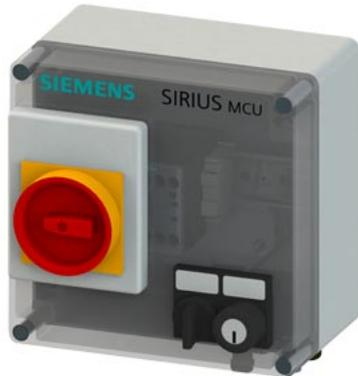
SIRIUS MCU Motorstarter Gehäuse Schutzart IP55 Kunststoff Kommunikation ohne elektromechanisch schaltend Kurzschlusschutz mit Leistungsschalter Direktstarter Bremse ohne Leistungsklasse 2 A Motorschutzleistungsschalter mit Bi-Metall thermisch Handbedienung rastend Anschluss Power M-Verschraubung EGH Ausführung
