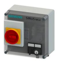
SIRIUS MCU Motorstarter Gehäuse Schutzart IP55 Kunststoff Kommunikation ohne elektromechanisch schaltend Kurzschlussschutz mit Leistungsschalter Direktstarter Bremse ohne Leistungsklasse 10 A Motorschutzleistungsschalter mit Bi-Metall thermisch Handbedienung rastend Anschluss Power M-Verschraubung EGH Ausführung
