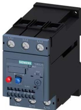
Überlastrelais 47...57 A thermisch für Motorschutz Baugröße S2, CLASS 10 Einzelaufstellung Hauptstromkreis: Schraub
