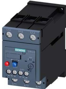
Überlastrelais 70...80 A thermisch für Motorschutz Baugröße S2, CLASS 10A Einzelaufstellung Hauptstromkreis: Schraub Hilfsstromkreis: Schraub Hand-Automatik-RESET
