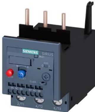
Überlastrelais 70...80 A thermisch für Motorschutz Baugröße S2, CLASS 10A Schützenbau Hauptstromkreis: Schraub
