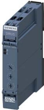
Zeitrelais, Multifunktion 1 Wechsler, 13 Funktionen 7 Zeitbereiche (0,05 s...100 h) AC/DC 12...240 V bei AC 50/60 Hz mit LED, Schraubanschluss
