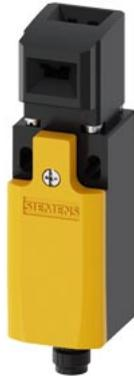
Sicherheits-Positionsschalter mit getrenntem Betätiger Kunststoffgehäuse, 31 mm nach DIN EN 50047 1S/1Ö Schleichkontakte 5 Anfahrrichtungen mit M12-Stecker, 4-polig Pin-Belegung: Pin1=21, Pin2=22 Pin3=13, Pin4=14 für maximal 250 V und 4 A der dazu passende getrennte Betätiger 3SE5000-0AV0. muss separat bestellt werden
