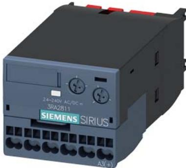
Elektronisches Zeitrelais ansprechverzögert mit Halbleiterausgang AC/DC 24-240 V Zeitbereich 0,05...100 s frontseitig aufschraubbar für Schütze 3RT2 S00/S0 und Hilfsschütze 3RH2 S00 Federzuganschluss Varistor zur Bedämpfung der Schützspulen integriert
