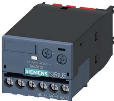
Elektronisches Zeitrelais rückfallverzögert mit Steuersignal und Halbleiterausgang AC/DC 24...240 V Zeitbereich 0,05...100 s frontseitig aufschraubbar für Schütze 3RT2 S00/S0 und Hilfsschütze 3RH2 S00 Schraubanschluss Varistor zur Bedämpfung der Schützspule integriert
