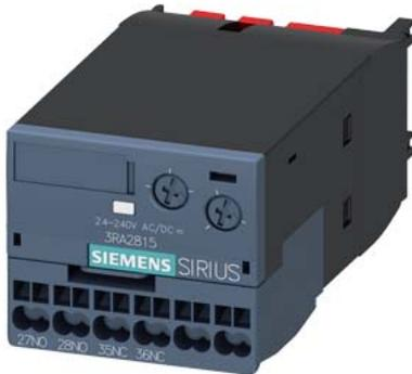
Elektronisch zeitverzögerter Hilfsschalter rückfallverzögert ohne Steuersignal Relais 1 Ö + 1 S AC/DC 24...240 V Zeitbereich 0,05...100 s frontseitig aufschnappbar für Schütze 3RT2 S00-S3 und Hilfsschütze 3RH2 S00 Federzuganschluss Varistor zur Bedämpfung der Schützspule integriert
