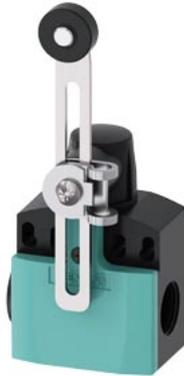
Positionsschalter Kunststoffgehäuse 50mm, Geräteanschluss 2 x (M20 x 1,5) 1S/1Ö Sprungkontakte, längenverstellbarer Schwenkhebel rechts/links einstellbar mit Kunststoffrolle 19 mm
