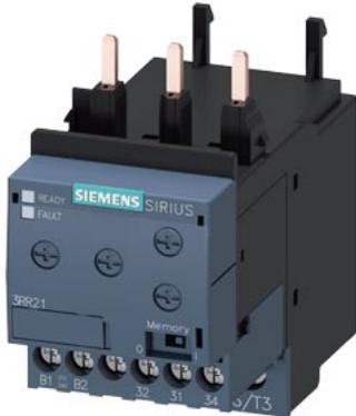
Überwachungsrelais, anbaubar an Schütz 3RT2, Baugröße S0 Basic, analog einstellbar Scheinstromüberwachung 4...40 A, 50...60 Hz, 2-phasig Versorgung 24 V AC/DC 1 Wechsler Überwachung auf Stromüber- und Unterschreitung Phasenausfall, Drahtbruch mit oder ohne Fehlerspeicher Anlaufverzögerung 0-60 s Störspitzenausblendung 0-30 s Schalthysterese 6% Schraubanschlusstechnik
