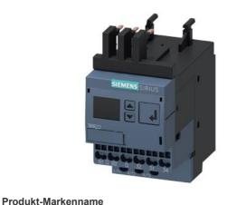
Überwachungsrelais, anbaubar an Schütz 3RT2, Baugröße S00 Standard, digital einstellbar Schein-/Wirkstromüberwachung 1,6-16 A, 20-400 Hz, 3-phasig Versorgung 24 V AC/DC 1 Wechsler, 1 Halbleiterausgang für Alarm und Warnung Überwachung auf Stromüber- und Unterschreitung Phasenausfall, Drahtbruch Phasenfolge Fehlerstrom Blockierstrom Warnung und Alarmschwellen mit oder ohne Fehlerspeicher Anlaufverzögerung 0-99 s Störspitzenausblendung 0-30 s Pause nach Fehler 0-300 min Federzugtechnik
