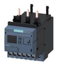
Überwachungsrelais, anbaubar an Schütz 3RT2, Baugröße S0 Standard, digital einstellbar Schein-/Wirkstromüberwachung 4...40 A, 20...400 Hz, 3-phasig Versorgung 24 V AC/DC 1 Wechsler, 1 Halbleiterausgang für Alarm und Warnung Überwachung auf Stromüber- und Unterschreitung Phasenausfall, Drahtbruch Phasenfolge Fehlerstrom Blockierstrom Warnung und Alarmschwellen mit oder ohne Fehlerspeicher Anlaufverzögerung 0-99 s Störspitzenausblendung 0-30 s Pause nach Fehler 0-300 min Schraubanschlusstechnik
