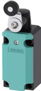
Positionsschalter Metall mit Schwenkhebel 40 mm, nach EN 50041 erhöhter Korrosionsschutz 1S/2Ö Sprungkontakte funktionsfähig bei -40 °C Schock- und Schwingprüfung nach DIN EN 61373, Kategorie 1B
