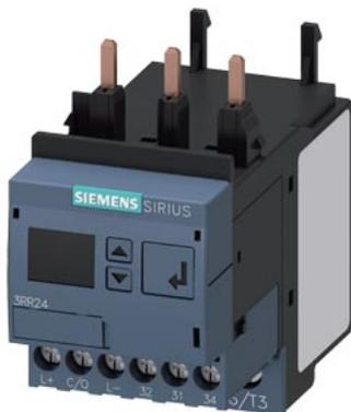
Stromüberwachungsrelais für IO-Link, anbaubar an Schütz 3RT2, Baugröße S0 Schein-/Wirkstromüberwachung 4-40 A, 20-400 Hz, 3-phasig Versorgungsspannung DC 24 V 1 Wechsler Überwachung auf Stromüber- und Unterschreitung Stromasymmetrie Phasenausfall, Drahtbruch Phasenfolge, Fehlerstrom Blockierstrom, Schaltspiel- und Betriebsstundenzähler Warn- und Alarmschwellen AUTO- oder HANDRESET Anlaufverzögerung 0-9999,9 s Ausschaltverzögerung 0-9999,9 s Wiedereinschaltverz. 0-300 min Schraubanschlusstechnik
