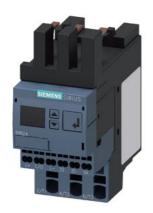
Stromüberwachungsrelais für IO-Link, anbaubar an Schütz, 3RT2, Baugröße S0 Schein-/Wirkstromüberwachung 4-40 A, 20-400 Hz, 3-phasig Versorgungsspannung DC 24 V 1 Wechsler Überwachung auf Stromüberund Unterschreitung Stromasymetrie Phasenausfall, Drahtbruch Phasenfolge, Fehlerstrom Blockierstrom, Schaltspiel- und Betriebsstundenzähler Warn- und Alarmschwellen AUTO- oder HANDRESET Anlaufverzögerung 0-9999,9 s Ausschaltverzögerung 0-9999,9 s Wiedereinschaltverz. 0-300 min Federzugtechnik
