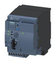
SIRIUS Kompaktabzweig Wendestarter 690 V AC/DC 110...240 V 50...60 Hz 1...4 A IP20 Anschluss Hauptstromkreis: steckbar, ohne Klemmen Anschluss Steuerstromkreis: Schraubanschluss
