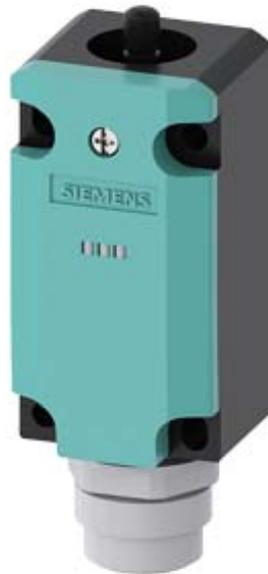
Basisschalter für Positionsschalter 3SE51 Metallgehäuse 40 mm nach DIN EN 50041 mit Stecker 6+PE nach EN 43651 mit 2 LED, gelb/grün DC 24 V 1S/1Ö Schleichkontakte ohne Antriebskopf Pin-Belegung: Pin1=21, Pin2=22 Pin3=14 und LED grün, Pin4=13 und LED gelb, Pin5=nicht angeschlossen, Pin6=Masse LED dazu passende Kabeldose 3SY3123
