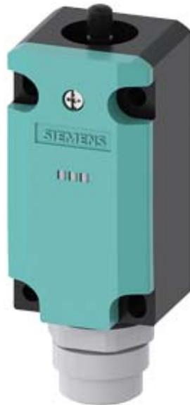
Basisschalter für Positionsschalter 3SE51 Metallgehäuse 40 mm nach DIN EN 50041 mit Stecker 6+PE nach EN 43651 mit 2 LED, gelb/grün DC 24 V 2Ö Sprungkontakte ohne Antriebskopf und 1 S für die LED-Anzeige Pin-Belegung: Pin1=21, Pin2=22 Pin3=31, Pin4=32, Pin5=13 LED grün, Pin6=Masse LED PE angeschlossen
