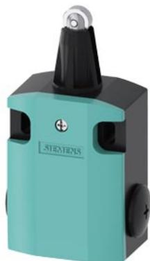
Positionsschalter Metallgehäuse 56 mm breit Geräteanschluss 3 x (M20 x 1,5) 1S/1Ö Sprungkontakte, Rollenstößel mit 3mm Überhub, Edelstahlrolle 13 mm Betätigungs-/Rückstellkraft 30 N, nur als Komplettgerät lieferbar
