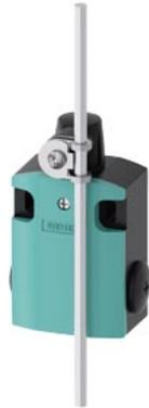
Positionsschalter Metallgehäuse 56 mm breit, Geräteanschluss 3x (M20x 1,5), 1S/1Ö Sprungkontakte, Schwenkantrieb rechts/links einstellbar, Stangenhebel aus Aluminium 200 mm lang
