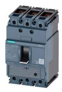
Leistungsschalter 3VA1 IEC Frame 160 Schaltvermögenklasse M Icu=55kA @ 415V 3-polig, Starterschutz TM120M, AM, In=100A ohne Überlastschutz Kurzschlussschutz Ii=5...15 x In Schraubenflachanschluss Spannungsauslöser (STL) 220-250 V DC; 208-277 V AC 2 Hilfsschalter HQ
