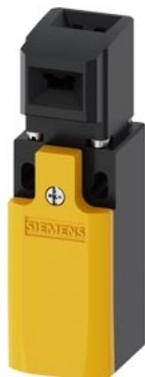
Sicherheits-Positionsschalter mit getrenntem Betätiger, Kunststoffgehäuse, 31 mm Geräteanschluss 1x (M20x 1,5) Schleifschiene 1Ö/1S 5 Anfahrrichtungen, der dazu passende getrennte Betätiger 3SE5000-0AV0.-0AW. muss separat bestellt werden
