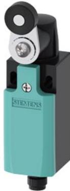
Positionsschalter Kunststoffgehäuse nach DIN EN 50047, 31 mm 1S/1Ö Sprungkontakte integriert (nicht austauschbar) mit M12-Stecker, 4-polig Pin-Belegung: Pin1=21, Pin2=22 Pin3=13, Pin4=14 für maximal 250 V und 4 A Schwenkhebel, recht und/oder links schaltend einstellbar mit Kunststoffrolle 19 mm
