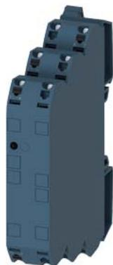
Trennwandler AC/DC 24-240 V, 3-Wege-Trennung Eingang: 0-10 V, 0/4-20 mA; Ausgang: 0-50/100Hz/1/10 kHz; Federzuganschluss (Push-In)
