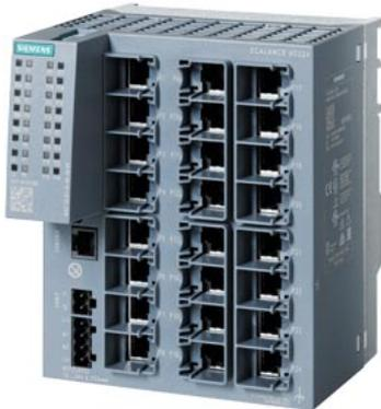
SCALANCE XC224 managebarer Layer 2 IE Switch; IEC 62443-4-2 zertifiziert; 24x 10/100 Mbit/s RJ45-Ports; 1x Konsolen-Port, Diagnose-LED; redundante Spannungsversorgung; Temp.-Bereich -40°C bis +70°C; Montage: Hut-/S7-Profileschiene/Wand Redundanzfunktionen Office Features (RSTP, VLAN, ...); PROFINET IO-Device Ethernet/IP-konform, C-PLUG Schacht;.
