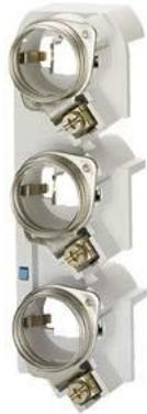
SR60-Sockel DIAZED DIII 3-polig AC 690V DC 500V für Passschraube für 5/10mm Schienenstärke mit Bügelschellen
