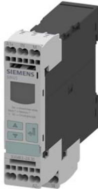
Digitales Überwachungsrelais Spannungsüberwachung, 22.5 mm von 10 bis 600V AC/DC Über- und Unterschreitung AC/DC 24 bis 240 V DC und AC 50 bis 60 Hz Störspitzenverzögerung 0,1 bis 20 s 1 Wechsler mit oder ohne Fehlerspeicher Federzugtechnik
