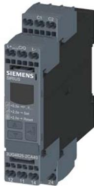
Digitales Überwachungsrelais zur Fehlerstromüberwachung mit Differenzstromwandler 3UL23 für IO-Link Einstellbereich 0,03 A bis 40 A getrennt für Warnschwelle und Abschaltwert Anlauf und Auslöseverzögerung 0 bis 999,9 s Abschalt-Hysterese bis 50% Warn-Hysterese 5% fest Breite 22,5mm, 2 Wechsler mit oder ohne Fehlerspeicher Federzugtechnik
