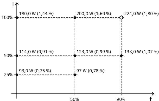
Die Prozentwerte geben die Verluste in Bezug auf die Bemessungsscheinleistung des Umrichters an.
