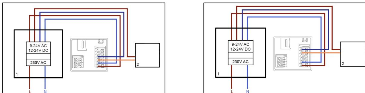
Zum Anschluss einer bereits vorhandenen Türklingel oder einem Aktor durch eine bestehende Verkabelung benötigen Sie mindestens 2 vorhandene Adern-Paare. Diese können von einem extra installierten Netzteil oder dem Klingeltrafo stammen (1). Prüfen Sie mit einem Strommesser, ob die benötigte Spannung für die Stromversorgung anliegt.
