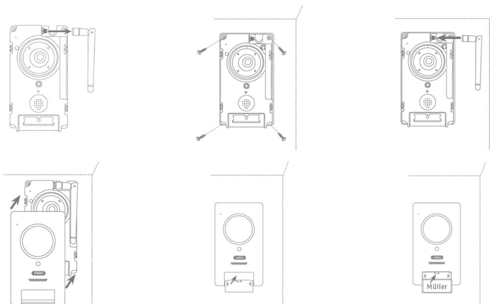
Zur finalen Montage schrauben Sie die Antenne an der Türstation ab, montieren Sie die Türstation mit den 4 beiliegenden Dreiecks-Schrauben und -Schraubendreher auf die Montageplatte. Schrauben Sie die Antenne wieder auf die Türstation und stecken Sie die Abdeckung auf die Türstation. Stecken zum Schluss die Klingeltaste-Druckplatte und die Klingeltaste-Abdeckung auf.
