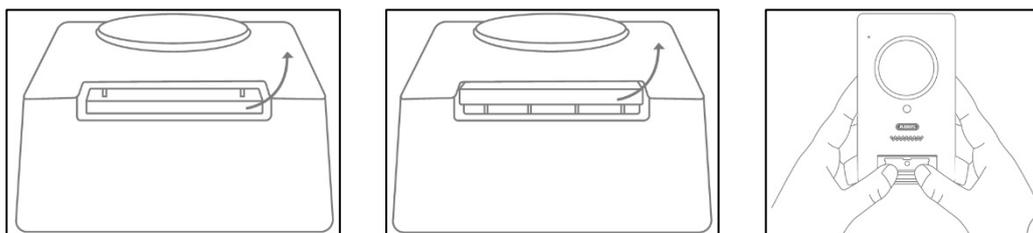
Die Türstation ist ab Werk mit der Klingeltasten-Abdeckung, der Klingeltasten-Druckplatte und der Abdeckung verbunden. Entfernen Sie zur weiteren Installation zuerst die Klingeltasten Abdeckung, anschließend die Klingeltaste-Druckplatte. Zum Abnehmen der Abdeckung üben Sie etwas Druck auf den nun offenen Klingeltasten-Bereich aus und ziehen Sie die Abdeckung von unten nach oben von der Türstation
