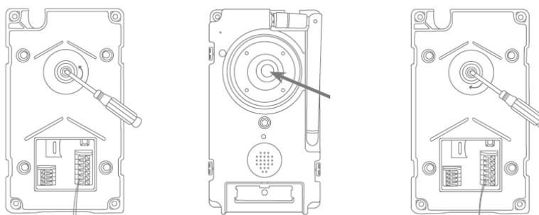
Das Objektiv der Türstation kann an der Rückseite um 7,5% vertikal und 2,5% horizontal verstellt werden. Zum justieren des Objektivs, lösen Sie die Schraube mit dem beiliegenden Dreieck Schraubendreher. Wir empfehlen Ihnen vor der finalen Montage, die Türsprechanlage zuerst mit der App2Cam Plus in Ihr Netzwerk einzubinden, um die perfekte Ausrichtung zu bestimmen. Arretieren Sie die Position des Objektivs, indem Sie die Schraube mit dem Dreieck Schraubendreher festziehen.
