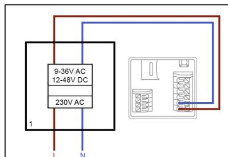
Zur Stromversorgung durch eine bestehende Verkabelung benötigen Sie mindestens 1 vorhandenes Adern-Paar. Diese können von einem extra installierten Netzteil oder dem Klingel Trafo stammen (1). Prüfen Sie mit einem Strommesser, ob die benötigte Spannung anliegt und verbinden Sie diese mit dem Anschlussblock V-/V+. Achten Sie bei einer Gleichstrom-Spannung auf die korrekte Polung.
