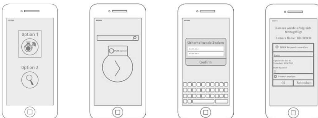
Öffnen Sie die App und wählen Sie die Option 1 zur Einrichtung der Kamera in Ihr WLAN-Netzwerk.
