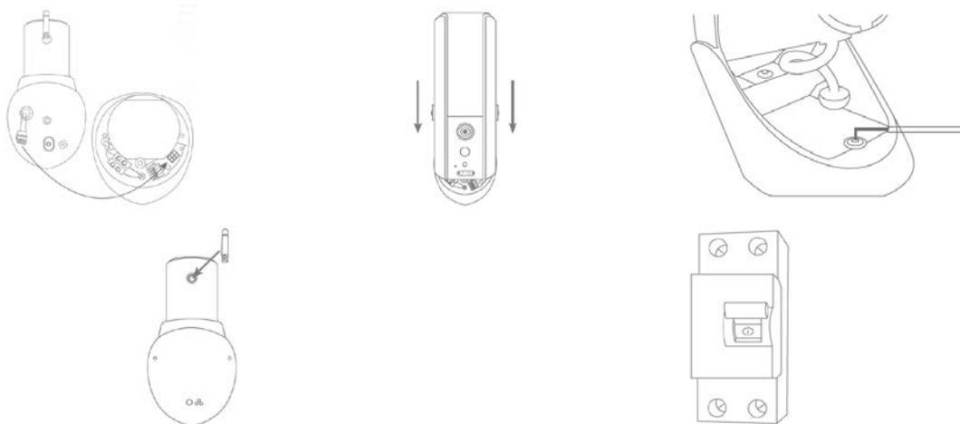
Verbinden Sie das Kamera Anschlusskabel mit dem Kamera Anschlussblock. Hängen Sie die Kamera anschließend auf die Halterung auf. Montieren Sie die Kamera auf die Halterung mit dem beiliegenden Inbus-Schlüssel. Montieren Sie die Antenne auf die Kamera. Versorgen Sie die Kamera nun mit Strom. Die Kamera ist zur weiteren Einrichtung bereit, wenn die Power LED durchgehend leuchtet und die Status LED 2x kurz, 1x lang blinkt.
