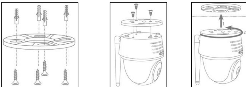
Legen Sie die Halterung an den gewünschten Installationsort der Kamera. Zeichnen und bohren Sie die benötigten Löcher. Verwenden Sie anschließend die beiliegenden Dübel und Schrauben, um die Halterung zu befestigen.
