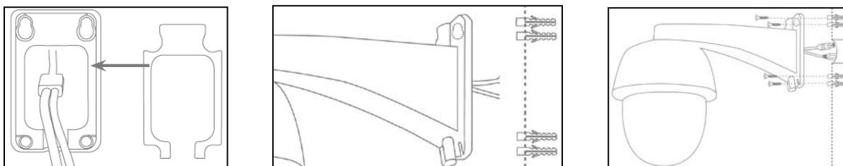
Wird die Kamera auf einer Rauputz-Wand installiert, verwenden Sie den beiliegenden EVA-Schaum und kleben Sie diesen auf die Rückseite der Halterung.
