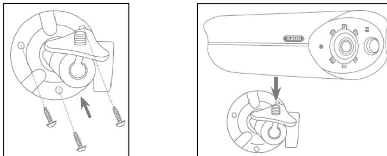
Legen Sie die Halterung an den gewünschten Installationsort der Kamera. Zeichnen und bohren Sie die benötigten Löcher. Verwenden Sie anschließend die beiliegenden Dübel und Schrauben, um die Halterung zu befestigen.
