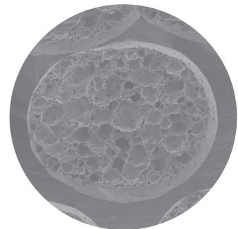
Multizelluläres, expandiertes Granulat aus Recyclingglas mit geschlossenen Poren.
