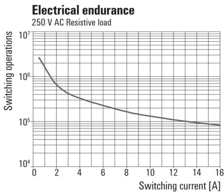
Elektrische Lebensdauer 230 V AC resistive load
