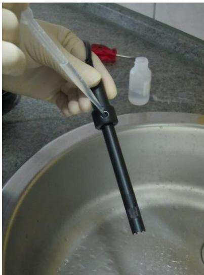
Abbildung: Befüllung mit Pipette
