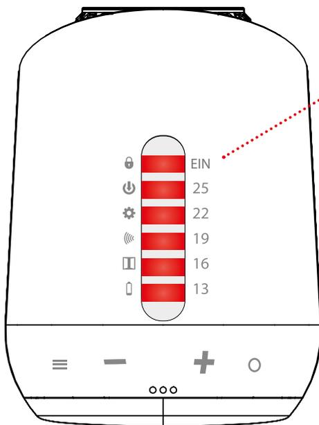
alle 6 LEDs an: > 28° = Heizung AN (Ventil voll geöffnet, keine Regelung)
