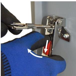
3. Drücken Sie den Sperrriegel des entsprechenden Spannverschlusses nach unten und bewegen Sie gleichzeitig den Verschlusshebel nach oben.
