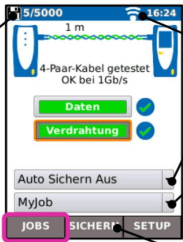
Zeigt Verbindung über Wi-Fi (WLAN) an.
