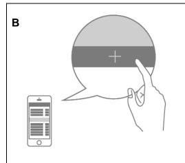
Aktivieren Sie den Inklusionsmodus (Einlernmodus) am primären Gateway. (nähere Details erfahren Sie in der Bedienungsanleitung des Gateways)
