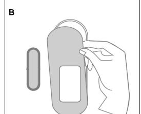
Entfernen Sie die Klebestreifenabdeckung vom Sensor und Magneten und befestigen diese an der gewünschten Montageposition
