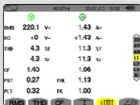
Die Oberschwingungsströme verursachen im Netz wachsende Verluste in den Wicklungen. Dadurch kann es sein, dass Transformatoren erhitzen und die Lebensdauer der angeschlossenen Geräte sinkt.
