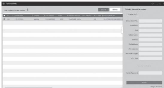
4. Nachdem der Scan des Hilfsprogramms abgeschlossen ist, klicken Sie mit doppeltem Mausclick auf den IP-Adressabschnitt der Kamera, auf den Sie zugreifen möchten.
