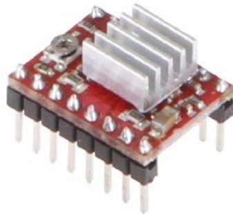
Nachdem die Jumper gesetzt wurden, können die Schrittmotortreiber in die schwarzen Steckplätze, welche sich direkt an den Jumpersteckplätzen befinden, eingesetzt werden. Achten Sie bitte darauf die Schrittmotortreiber richtig einzusetzen. Die Beschriftungen an den Pins der Treiber sollten mit den Beschriftungen auf dem Ramps-Erweiterungsboard übereinstimmen. Nach dem erfolgreichen Einsatz der Motortreiber können nun die entsprechenden Schrittmotoren angeschlossen werden.
