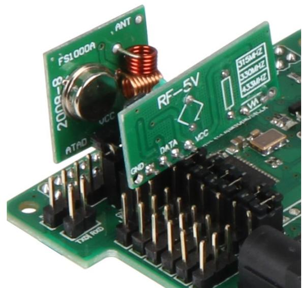
**Achtung!** Bitte beachten Sie, dass eine Verwendung der 433MHz Module mit der gleichzeitigen Verwendung der **Driver1** und **Driver2** Anschlüsse nicht möglich ist.
