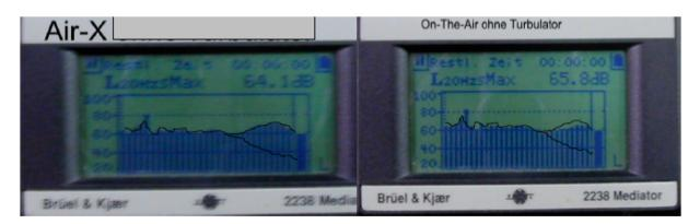
Als Referenzlinien sind jeweils die Schallpegel des Windkanals mit Generatorgehäuse ohne Rotor eingezeichnet.
