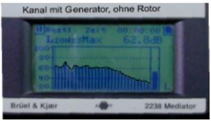
Bis zu einer Frequenz von 1kHz liegt der Geräuschpegel des Windkanals relativ konstant bei 60dB-oberhalb der 1kHz Grenze fällt der Geräuschpegel auf ca. 30 dB. Bei 40 Hz ist ein kleiner Peak festzustellen, der wahrscheinlich vom Antrieb des Kanals herrührt.
