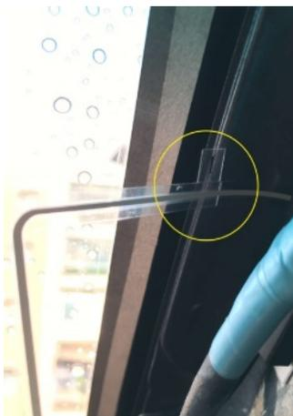
3. Entfernen Sie vorsichtig die Schutzfolie von der Folien-Antenne. Befestigen Sie das kurze horizontale Stück gem. der Struktur der A-Säule.
