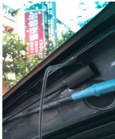
2. Befestigen Sie den Verstärker an der A-Säule. Bitte sicherstellen, dass die Fläche sauber ist.
