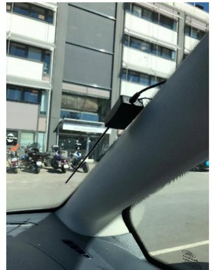
4. Verbinden Sie die Masse-Leitung (Klebefolie bei AD01 und Magnet-Verbindung bei AD01+) mit der A-Säule.
