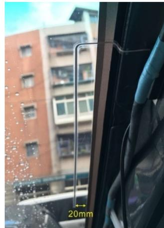
4. Die Folien-Antenne wird vertikal (niemals horizontal) befestigt. Das Ende der Antenne sollte ca. 20mm von dem Chassis entfernt sein.
