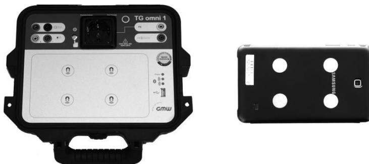
Im Lieferumfang befinden sich vier Metallscheiben. Legen Sie diese auf die Magnetsymbole des geöffneten Prüfgerätes. Entfernen Sie die Schutzfolie von den Klebeflächen. Legen Sie das Tablet in den angezeigten Rahmen der Frontplatte auf die Scheiben und drücken Sie es fest an. Die Scheiben bleiben am Tablet bzw. dessen Hülle haften. Drehen Sie das Tablet um und pressen Sie die Metallscheiben einzeln auf das Tablet bzw. die Hülle.
